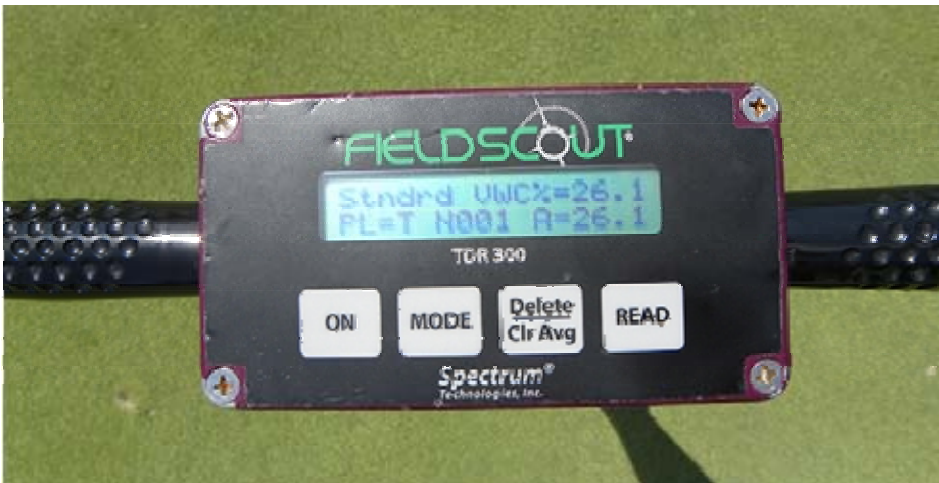
Field Scout水分計は体積含水率をパーセント値で表示してくれるので、使いやすく、測定結果も見やすい。
