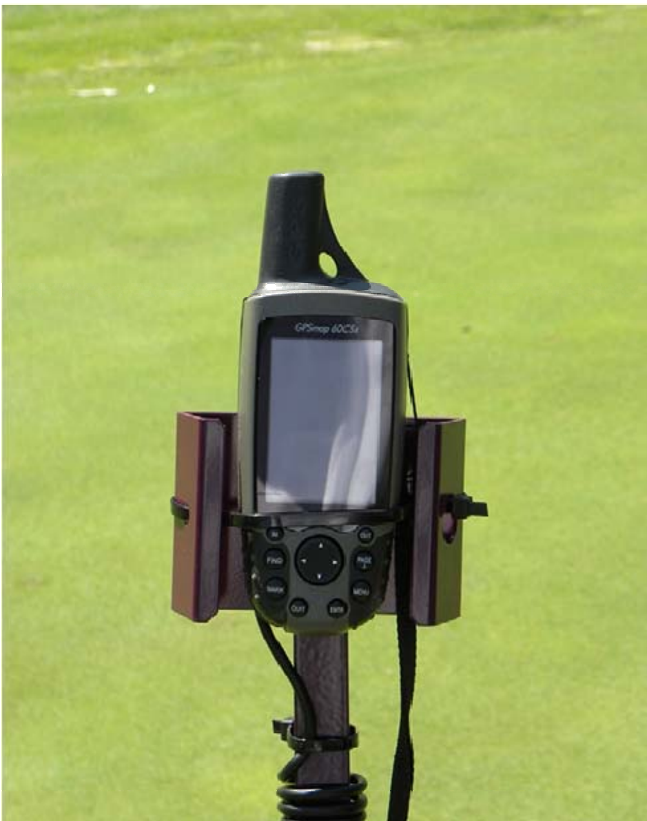
Field Scout水分計にGPS受信機を組み合わせると、グリーンの形状だけでなく勾配も含めた正確なマップを作成することもできる。
