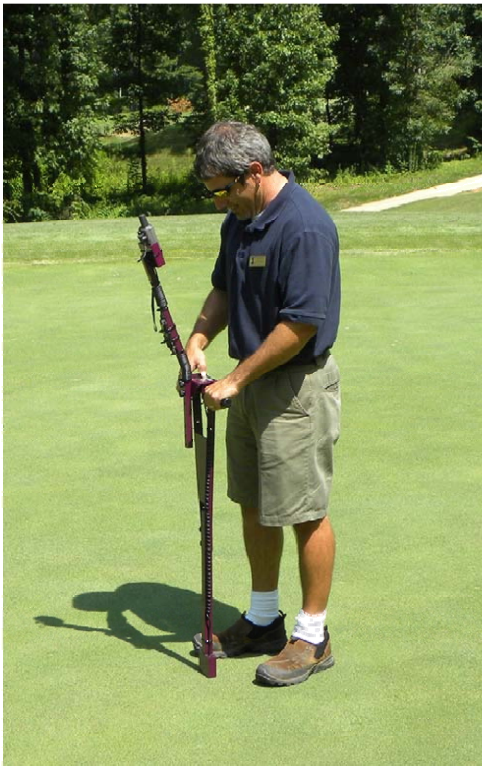
ザ・ショールズにあるロバートトレントジョーンズトレイルのスーパーインテンドント、ランディ・ガトリンは、グリーンへの土壌水分をより精密に把握するために、日常的にField Scout水分計を使っている。
